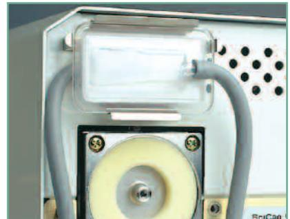
Un filtro biológico impide la entrada a la cámara de esterilización durante el ciclo de secado a las bacterias o esporas de más de 0.3 µm. Este eficaz sistema de filtración de aire proporciona al usuario un cómodo acceso a los filtros que facilita la tarea de sustitución de filtros.
